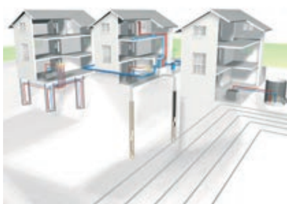
Sfruttamento del calore terrestre con RAUGEO: un sistema geotermico composto da tubi, sonde, collettori e pilastri energetici
